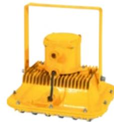
外壳采用铝合金压铸成型，表面高压静电喷塑，钢化玻璃灯罩，防护网罩采用 65Mn 弹簧钢表面镀铬。
