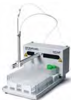
ASX280配备180位样品架及10位标准样式管架
