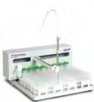
ASX560 配备360位样品架及16位标准样式管架
